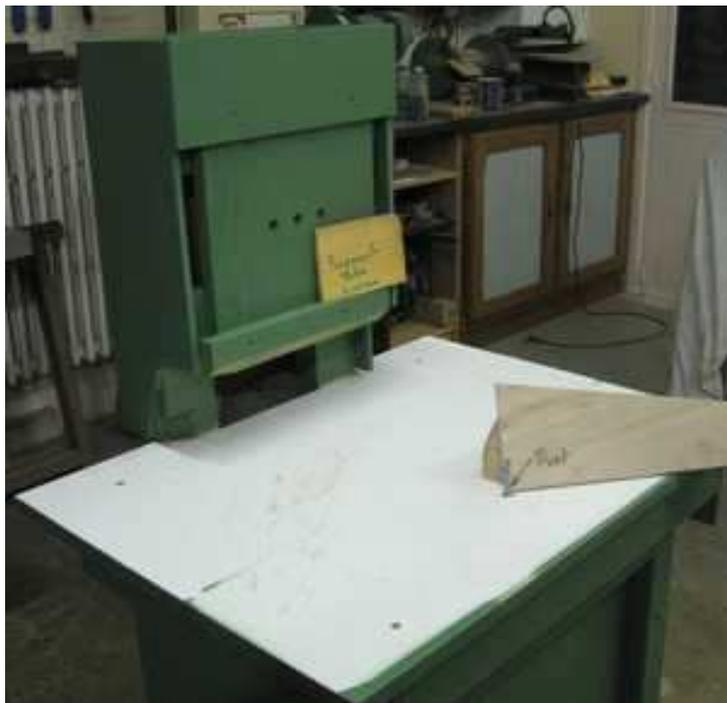
2/ La tige filetée du pivot est fixée sur la table et la table croisée sur le support vertical
