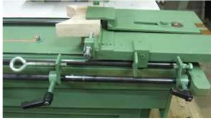
4/ Règle permettant le réglage du rayon, ce dernier est en appui sur les deux petites équerres
