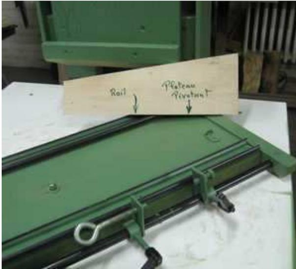
6/ Gros plan sur les deux curseurs pour le réglage fin et l'immobilisation grâce à la bride en haut à droite
