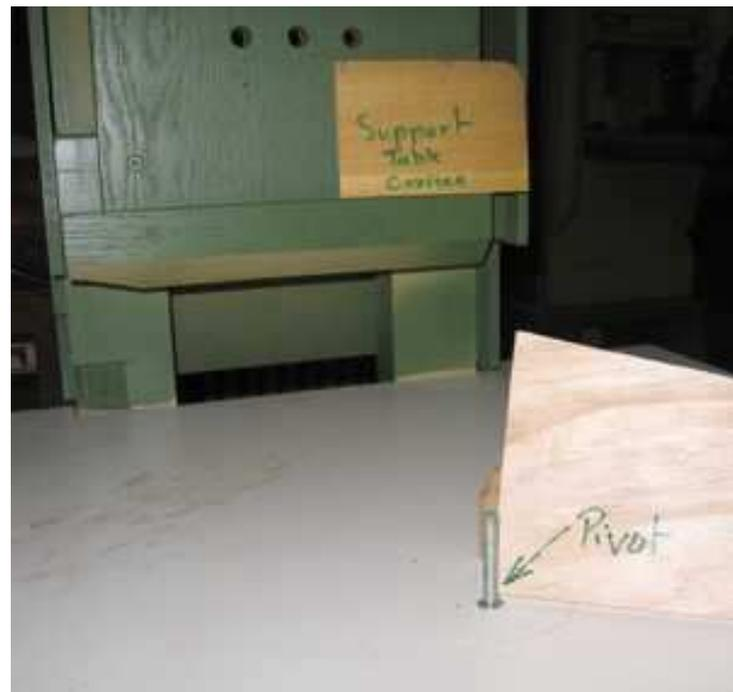
3/ Plateau pivotant sur l'axe de la table, au premier plan, le curseur avec la vis de réglage du chariot
